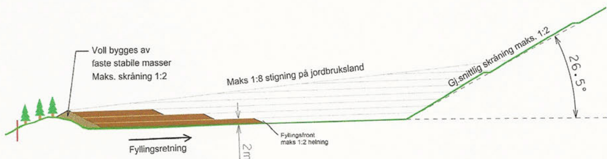
Figur 10 Prinsippskisse lagvis innfylling av deponimasse
