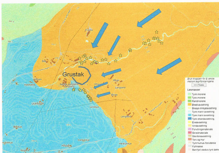
Figur 8 Løsmassekart med antatte hovedstrømningsretninger for grunnvann (AsplanViak /2/)
