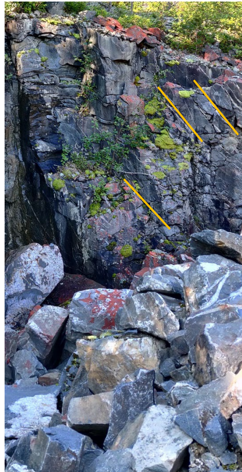
Figur 4: To bilder som viser typisk oppsprekking av bergarten. Til venstre: steile sprekker. Til høyre: skjærsprekker. Sprekkeformen til venstre dominerer.
