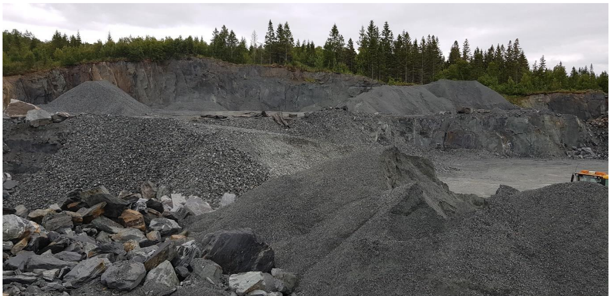
Langs pallvegg mot øst vil bryting skje parallelt med lagdelingen som gir glatte jevne bruddvegger.
