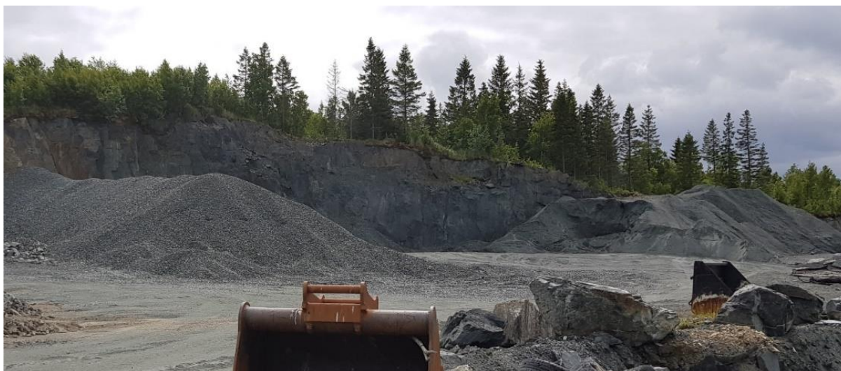
Fig.7: Bruddvegg mot øst og fylkesvegen følger vertikal lagdeling som gir en ryddig overflate.
