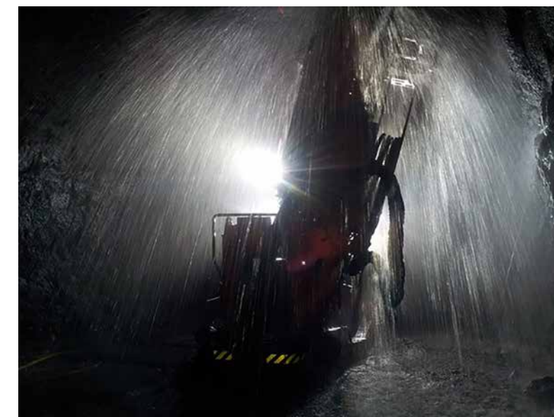
Langhullsriggeren borer hull til sprenging i malmen.
