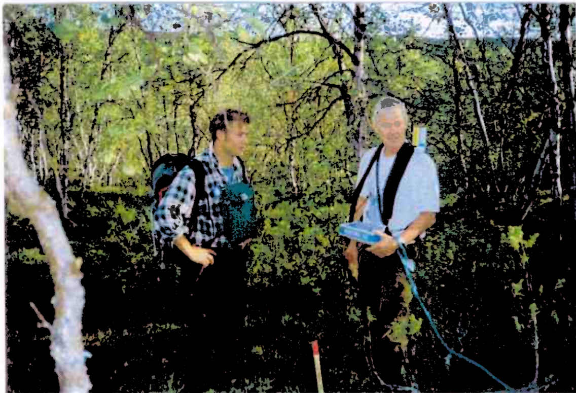
Foto 1: Fremste mann på geofysikklaget holder retning på linjen, setter staker og leser av magnetometer. (Foto: B. Flood)
