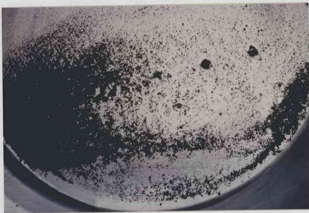
Fig. 6 . Ferdigvasket tilfredsstillende rent konsentrat av tung-mineraler. De svarte korn er vesentlig magnetitt. De lyse korn bl.a. zirkon og titanitt foruten noen korn av lyse, lette mineraler (kvarts og feltspat) som ikke er vasket ut.
