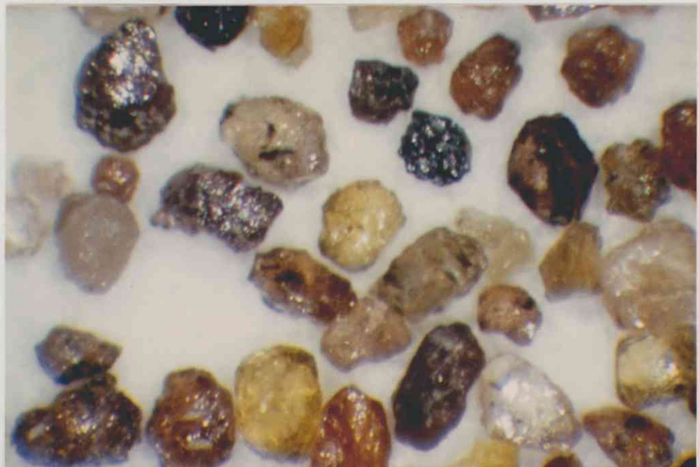
Fig. 8 . 50x forstørrelse. Prøve MV 200. Separert med tung væske (sp.v. 3,3). Brunlige korn: titanitt, glassklare korn: zirkon, mørke, metalliske korn: rutil, grønne korn: epidot.
