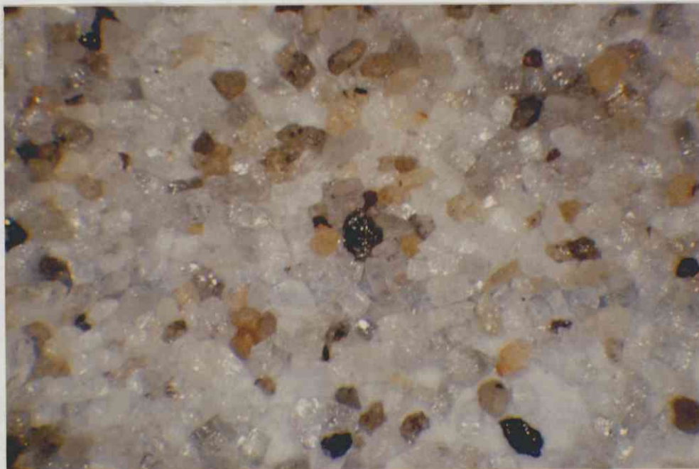
Fig. 9 . 18x forstørrelse. Prøve MV 231. Separert med tung væske (sp.v. 3,3) og Franz-separator (umagn. ved 1,0 ampère). Glassklare til melkehvite korn: zirkon, gullbrune-gråbrune korn: titanitt, svarte, metalliske korn: rutil.
