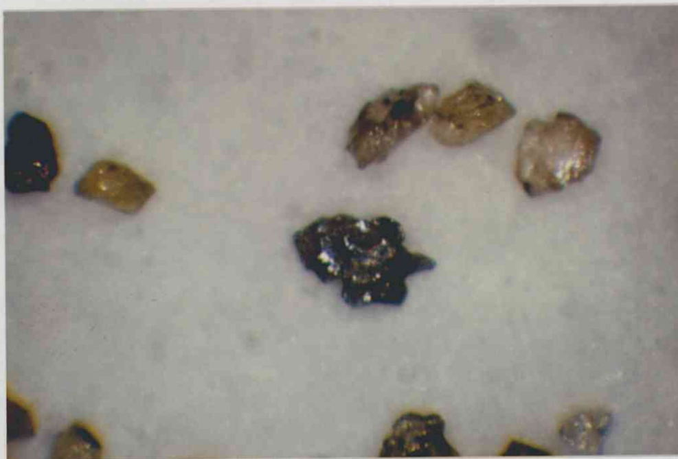
Fig. 11 . 50x forstørrelse. Prøve MV 202. Separert med tung væske (sp.v. 3,3). Et korn av molybdenglans MoS 2 midt på bildet.
