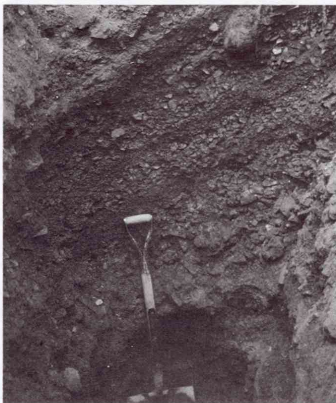
Fig. 2. Nærbilde av sjakt i erosjonsskrenten mot elven hvor betongprøven ble tatt i det underste sandige-grusige laget ved spaden.
