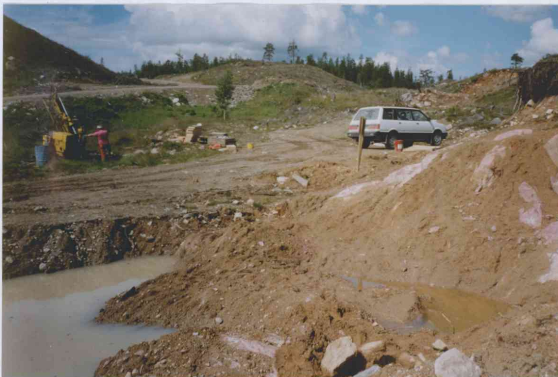
Fig. 4 : Oversiktsbilde sett mot NV som viser utgående av thulitt/ piedmontitt forekomsten. Bormaskinen står ved Bh 3/91 og borer - 60° i profilretningen mot øst (se profilet Fig. 2).
