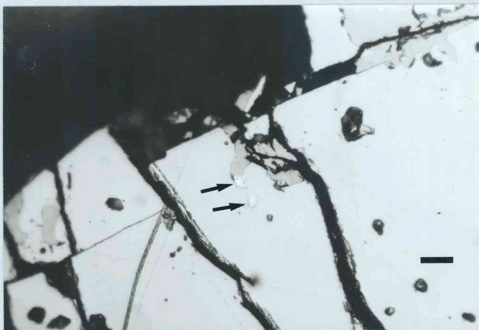
Fig. 3 B. To gullkorn (hvite, se piler) i poikilittisk og kataklastisk svovelkis (lys grå). Kobberkis (grå) opptre vesentlig som sprekkefyllinger i svovelkis. Ikke-opake faser er sorte. Målestokk: 15 \mu m.
