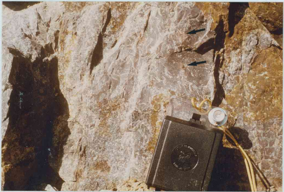
Fig. 4 A. Kvartsårer i tett, brun albittfels med daviditt. To eksempler på daviditt-korn med rød metamikt halo er merket med piler. Fra vestkant av dagbrudd A.
