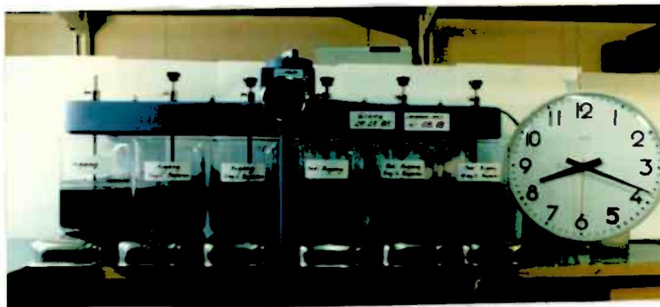
Fig. 2.1 Jarrest. Grong 07.07.85. 30 sek. langsom omrøring
