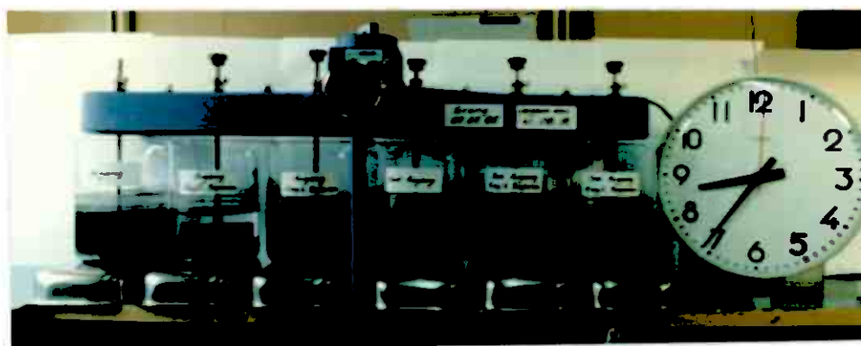
Fig. 2.2 Jarrest. Grong 07.07.85. 18 min. langsom omrøring
