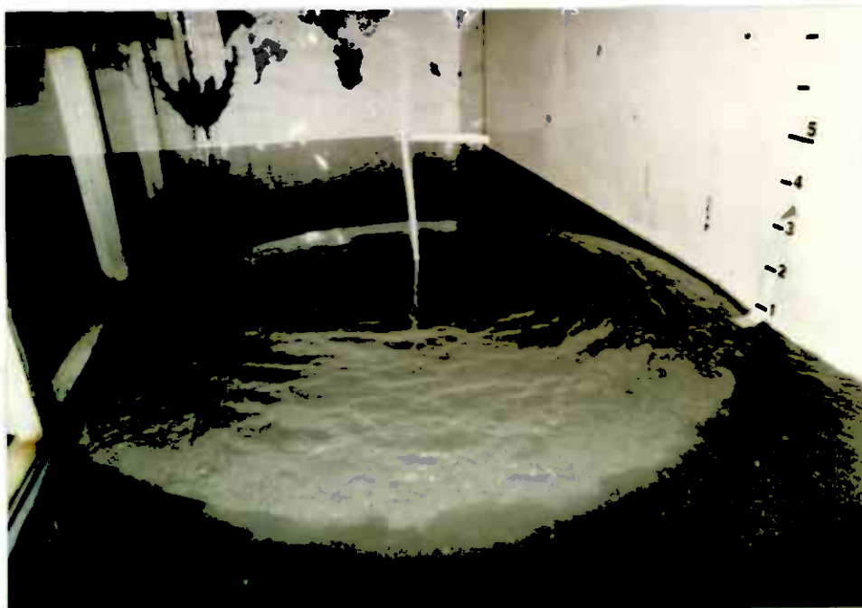
Fig. 4.6 Typisk fordeling av slam på bunnen av bassenget ved flere av forsøkene etter nedtapping av vannfasen.
