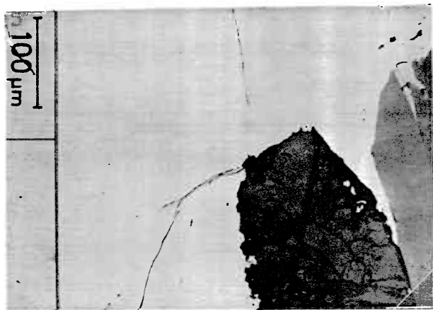
Fig. 36. Fra kvarts-feldspat mobiliseringer med molybdenglans. I et pyritkorn ses til venstre i billedet et guld-korn. Kernen langt mod højre er molybdenglans. Til venstre for dette er der et indkapslet magnetitkorn.
