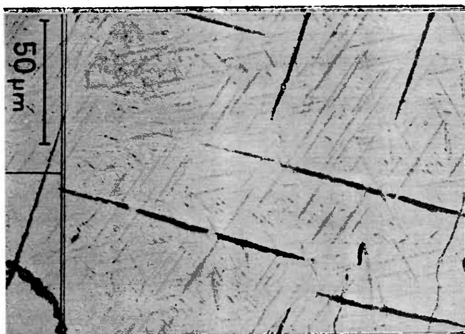
Fig. 16. Titanomagnetit fra pyribolit. Der findes en tidlig afblandingsfase af ilmenit, og en senere af spinel (sorte aflange lameller).
