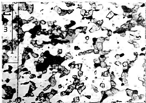
Fig. 13. Pyribolit (20225) næsten uden biotit og hornblende. Prøven udviser ikke foliation.
