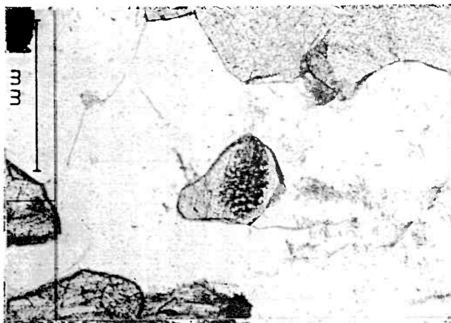
Fig. 15. I midten af billedet ses et diopsidkorn, der udviser myrmekitisk sammenvoksning med et opakt mineral.
