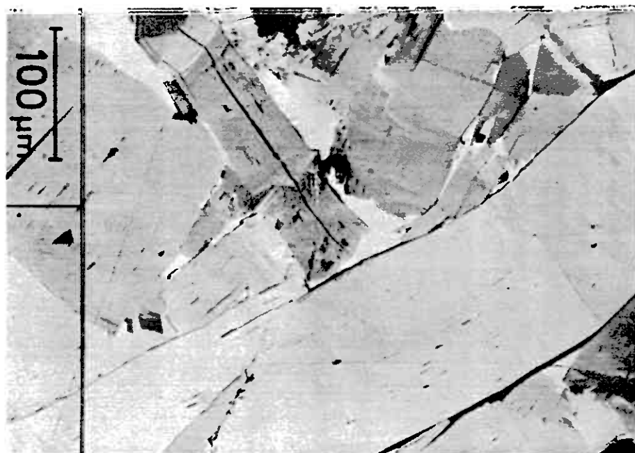
Fig. 31. Kvarts-feldspat mobiliseringer med molybdenglans. Svagt deformerede molybdenglanskorn med kobberkisudfældninger i hulrum imellem molybdenglanskornene.
