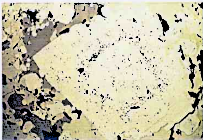
Zonengebauter Pyritblast in Kupferkies-Magnetkies-Erz. Die zonenartig gehäuften Einschlüsse im Kristall sind Magnetkies, Kupferkies, Zinkblende und Gangart.
