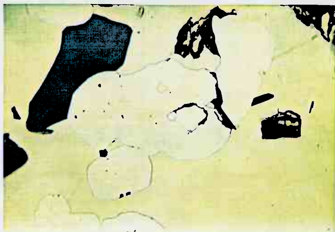
Gerundeter Pyrit in Kupferkies mit Amalgameinschluß (weiß) Punktanalyse: 55% Ag, 20% Au, 25% Hg, Sp. Cu.
