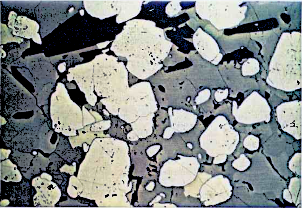
Durchbewegterz. Gerundete Pyritblasten in einer Magnetkiesmatrix, sowie wenig Kupferkies. Die Pyrite sind reich an Mikroeingeschlüssen. Der Magnetkies ist sehr gleich- körnig (Rekristallisationsgefüge).
