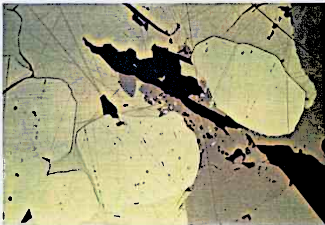
Silberamalgamkörner in Magnetkies (etwa 5 µm Ø) Punktanalyse: etwa 50% Au, 50% Hg, Spuren von Au u. Cu. Ausschnitt aus oberer Aufnahme; (85/5/5) vergr. ca. 500 mal, Bildlängskante 0,22 mm, // Nicols
