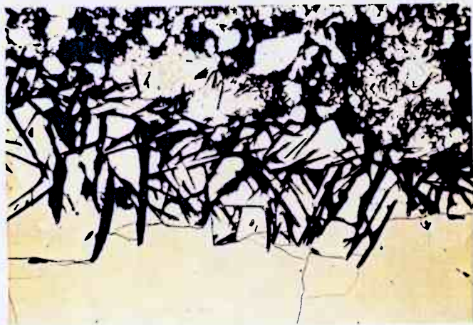
Quergewachsene nadelförmige Aktinolithkristalle (schwarz) am Kontakt zwischen Magnetkies (unterer Bildteil) und gangartreichem Pyriterz (oberer Bildteil) mit etwas Kupferkies.
