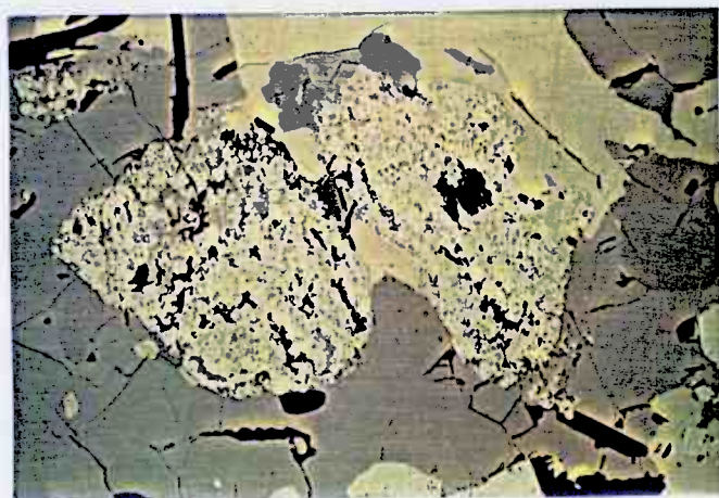
Durchbewegterz. Aggregate von feinkörnigem, brecciertem Pyrit in einer Kupferkies (gelb)-Magnetkies (tombakbraun) Grundmasse.
