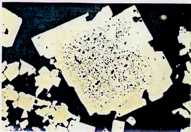
Pyritidoblast mit Zonenbau. Im Kern sehr reich an Gangarteinschlüssen (hier meist Quarz), im Außenbereich fast einschlußfrei.
