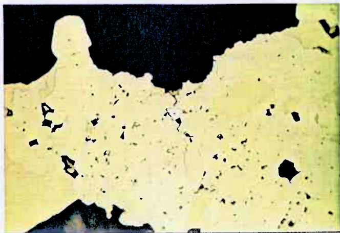
Anduskorn auf RIB in Pyritaggregat. Der Pyrit ist reich an Einschlüssen von Kupferkies und Gangart. Punktanalyse: 50% Ag, 5% Au, 35% Hg.
