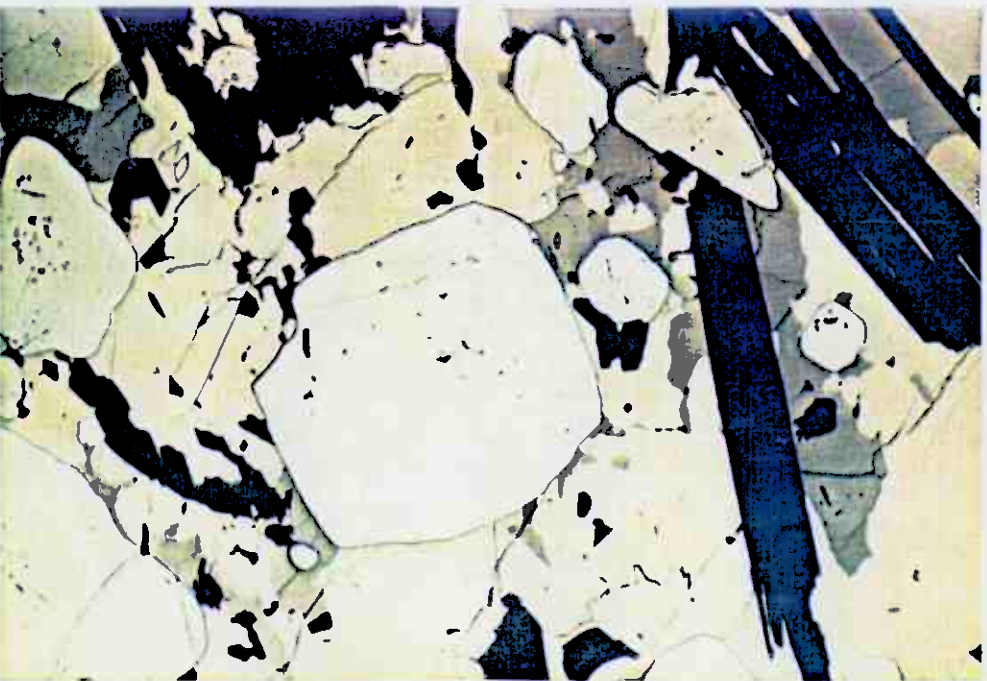
Durchbewegterz. Gerundete Pyritblasten in einer Kupferkies (gelb)- Magnetkies (bräunlichgrau)-Grundmasse. Längs gestreckte, idiomorphe Aktinolith-Kristalle durchschlagen die Matrixsulfide
