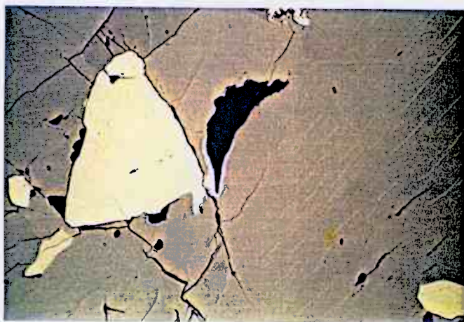
Mackinawit (weiß, in H-Stellung) in Magnetkies (braun), als Saum um einen Gangarteinschluß (schwarz). Der Magnetkies zeigt ein lamellares Internegefüge. Links Pyritblast (gelblichweiß).
