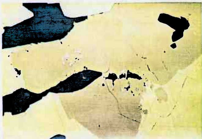
Silberamalgameinschlüsse (weiß) im Magnetkies (tombakbraun), umgeben von Kupferkies und etwas Pyrit. Punktanalyse: etwa 70% Hg, 30% Ag
