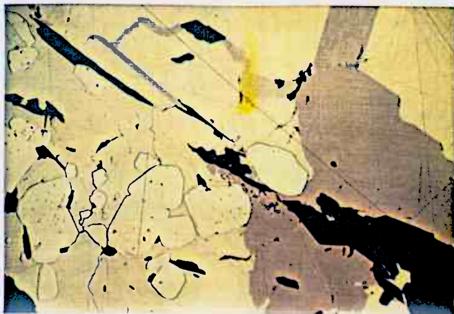
Kupferkies-Magnetkies-Erz mit gerundeten Pyritblasten. Im Kupferkies (gelb) ist lamellenförmig Cubanit 1 entmischt. In Bildmitte Einschlüsse von Silberamalgam 2 in Magnetkies (tombakbraun)
