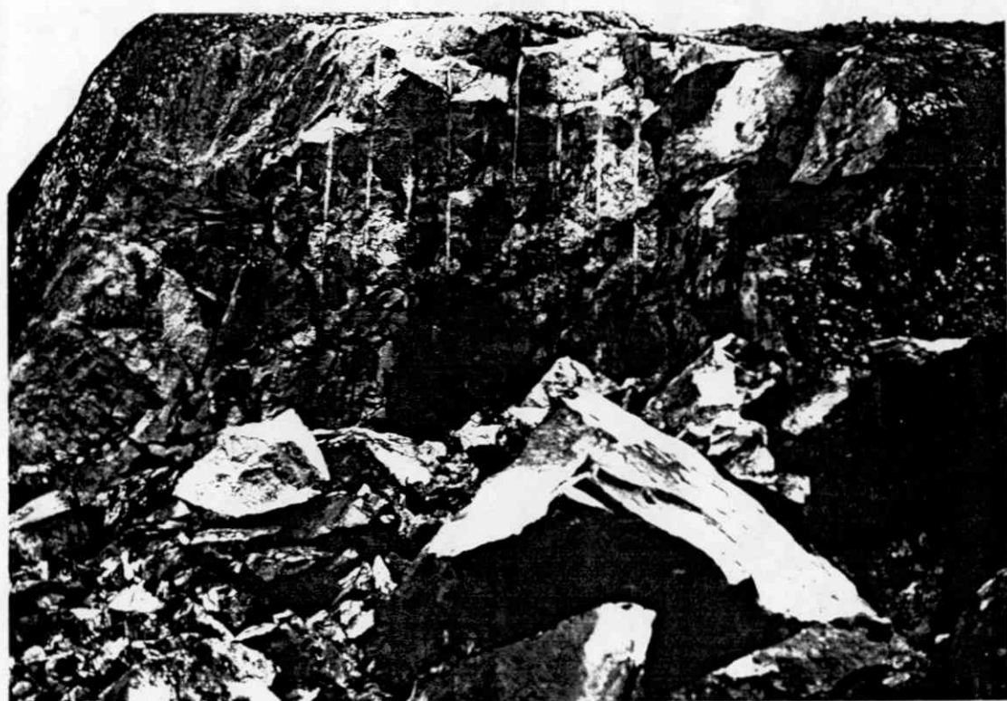
Fig. 3: Nærbilde av øvre salve i Syd. Steinen sprekker opp i sprekker med oksydebelegg (svakt brunt).
