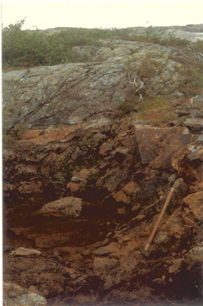
Fig. 5.8. Skjerp i Gammelannlia (1365x, 900y). Massiv svovelkis er synlig på oversiden av hammer-skaftet. Bak skjerpet sees klorittrikt agglomerat, og helt i bakgrunnen det felsiske agglomeratet. Fotoet er tatt mot nord.
