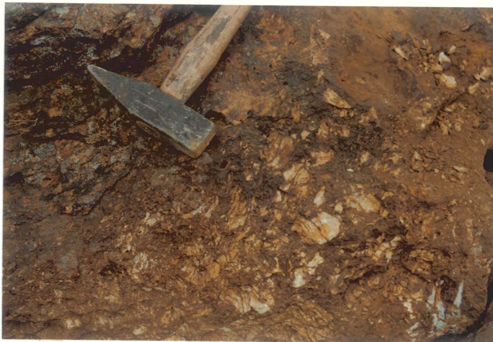
Fig. 5.13. Jernhatt ved Annliffjellet (535x, 1090y). De lyse fragmentene består av hydrotermalt omvandlede bergarter.
