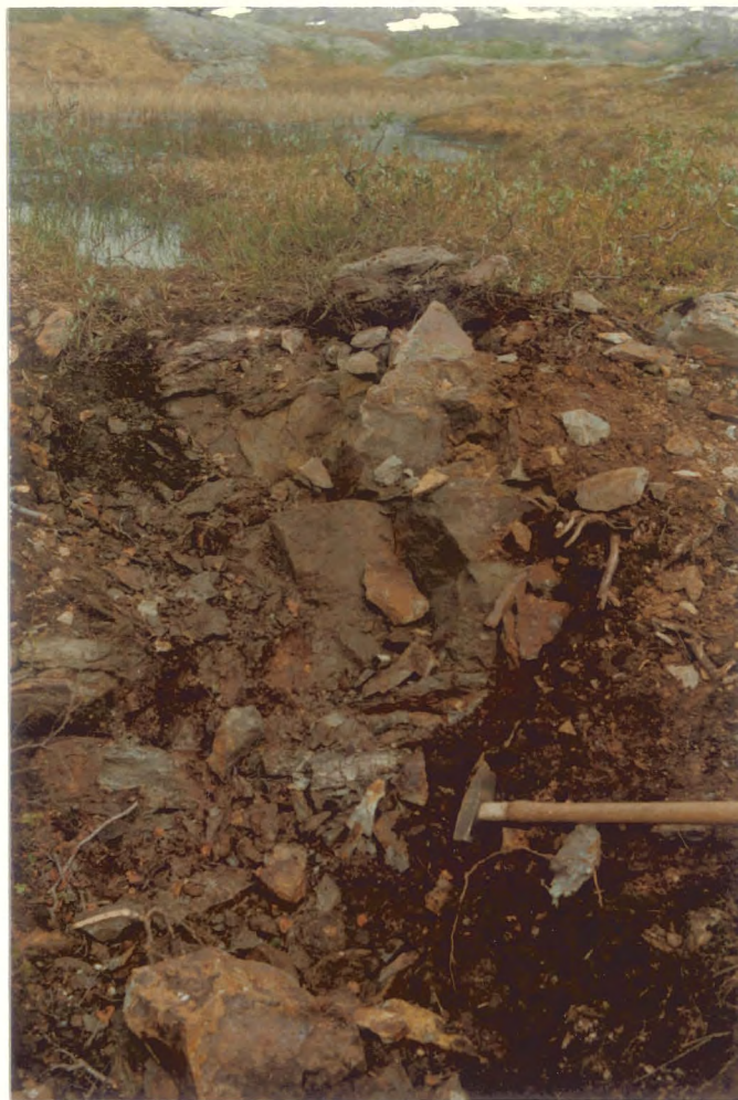
Fig. 5.11. Prøvetatt skjerp ved 645x, 895y. 0,6 m tykk benk med massiv svovelkis er blottet. Bildet er tatt mot nordvest.
