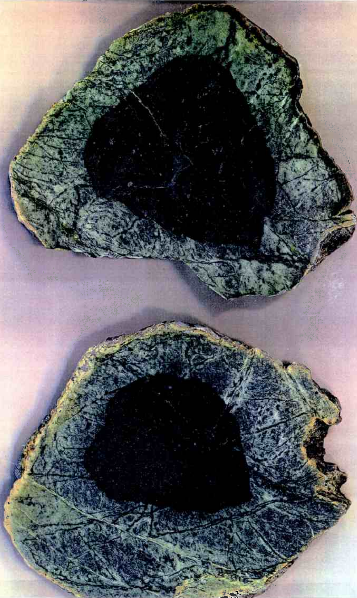
Figur 8 Polerte skiver av prøve fra forekomsten. Naturlig målestokk
