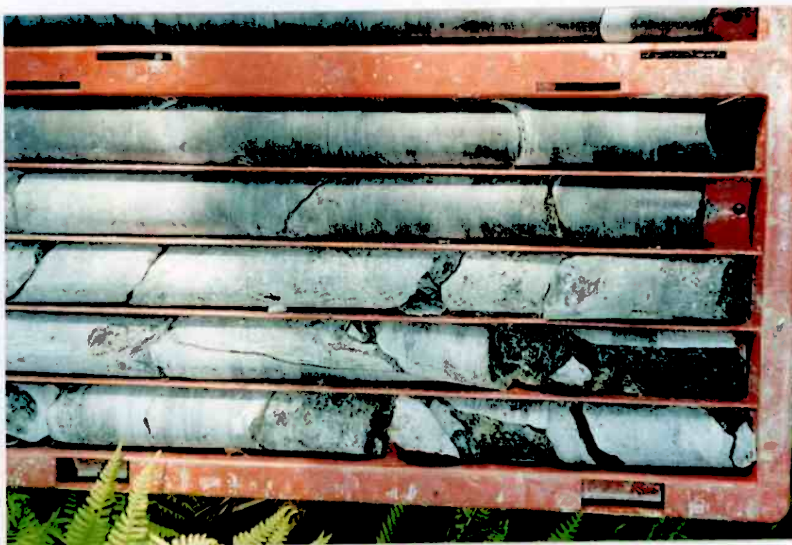
Fig. 5 Viser et parti på ca. 5 meter med sterkt oppknust materiale fra BH-4-94.
