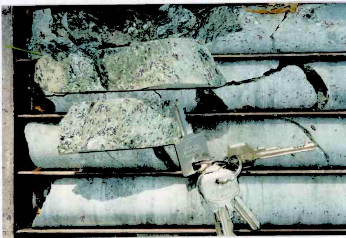
Fig. 4 Viser kjernemateriale som er karakteristisk for de sterkt oppknust sone med kloritt og biotittrikt materiale.
