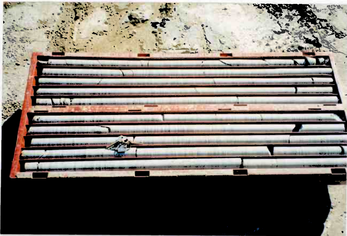
Fig. 7 Foto av en 10 meter mektig sone med relativt massiv og lite oppsprukket kleber. Endel av sprekkenes på bildet skyldes delvis hard behandling og avrivning i borestrengen. BH-3-94.
