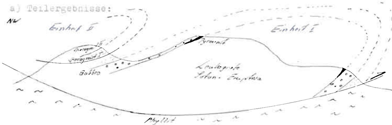
a.) Stratigraphie. Der stratigraphische Aufbau Espedalens geht aus obiger Abbildung, einem schematischen NW-SE Profil, hervor.
