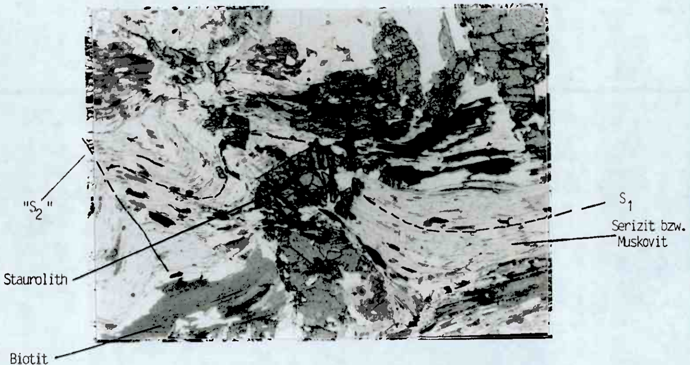
Abbildung 3.7: Staurolith (Bildmitte) im Granat-Glimmerschiefer (Probe 43). Die Schichtsilikate (hier hauptsächlich Serizit bzw. Muskovit) sind in Mikrofalten gelegt und in der Bildmitte rechts und links des Stauroliths zu erkennen. In den oberen Bildecken sind jeweils Hornblende-kristalle zu sehen (Bildbreite 3,5 mm, Nicols ||).
