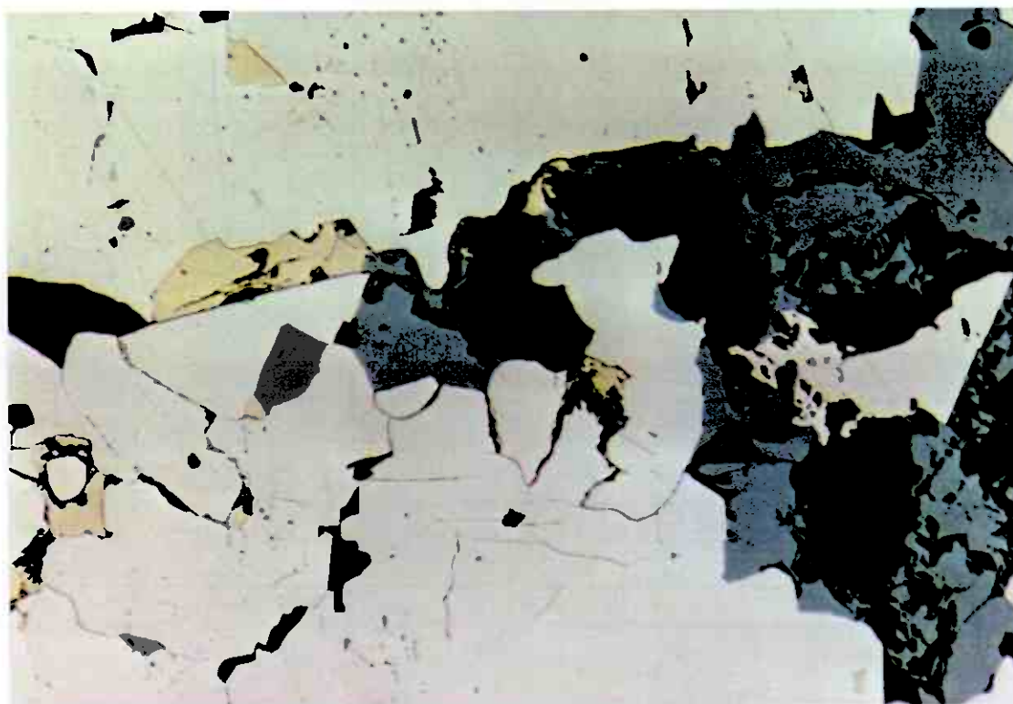
Figur 8. SR 03. Skiftesmyr. Pålys. Gul kobberkis og grå zinkblende som delvis er innesluttet i lys gul svovelkis. Bildets bredde er ca. 2 mm.
