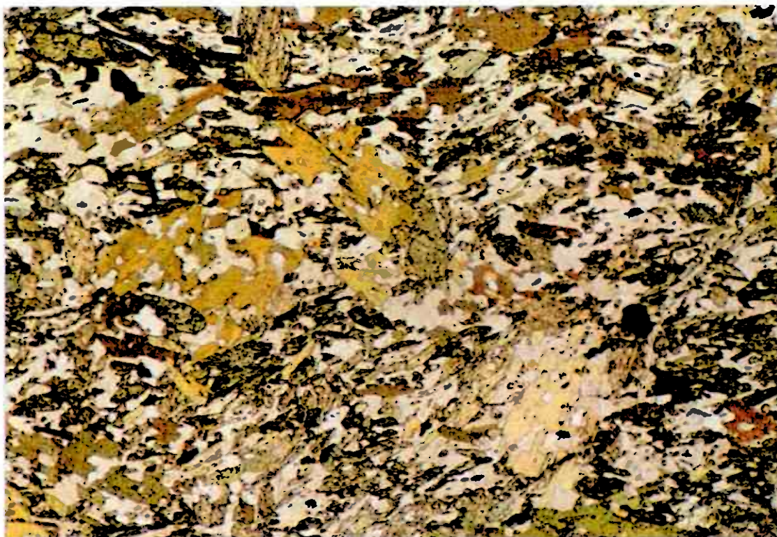
Figur 5. JA 10b. Joma. De lyseste kornene er plagioklas eller kvarts. Grønn hornblende skiller seg ut på grunn av spalterissene, mens biotitten er lys - mørk brun, ofte med inneslutninger av kvarts. Nede til venstre sees grønn kloritt mens ved høyre side, nær nedre hjørne sees korn av klorozoisitt med inneslutning av kvarts. Bildets bredde er ca. 4 mm.
