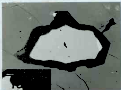
Ilmenit (det lyse hjørne er rutil) omgivet af titanit. Det hele omgivet af granat. Prøve nr. E 107.
