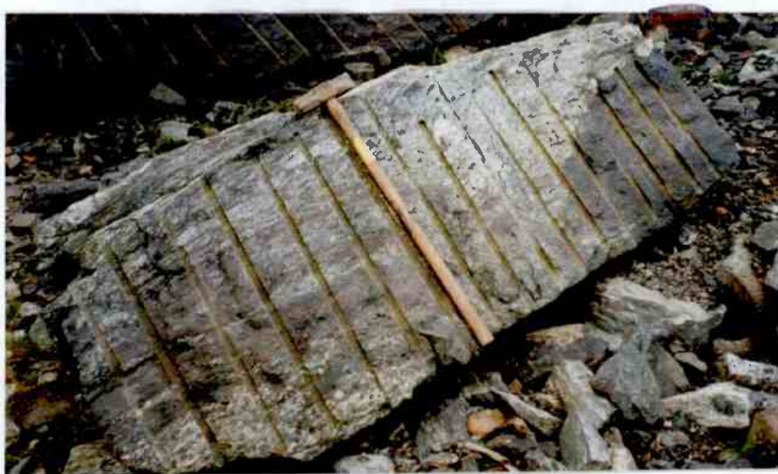
Fig. 6 Langkilt blokk-emne fra Prøvebrudd Utpreget sekunda materiale Sørdal
