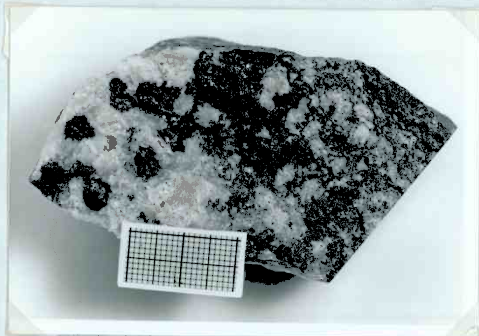
Fig.12. Grube John.Kvartsåre og sidesten.Målestok: 20 mm.I den grovkornede kvartsåre findes mineralaggregater af bornit med chalcosin/digenit.I sidestenen ses utydeligt irregulære lyse amoeboide chalcosin/digenit-korn.Den i billedets højre side lige afskårne flade vinkelret på billedfladen er gengivet i figur 13.
