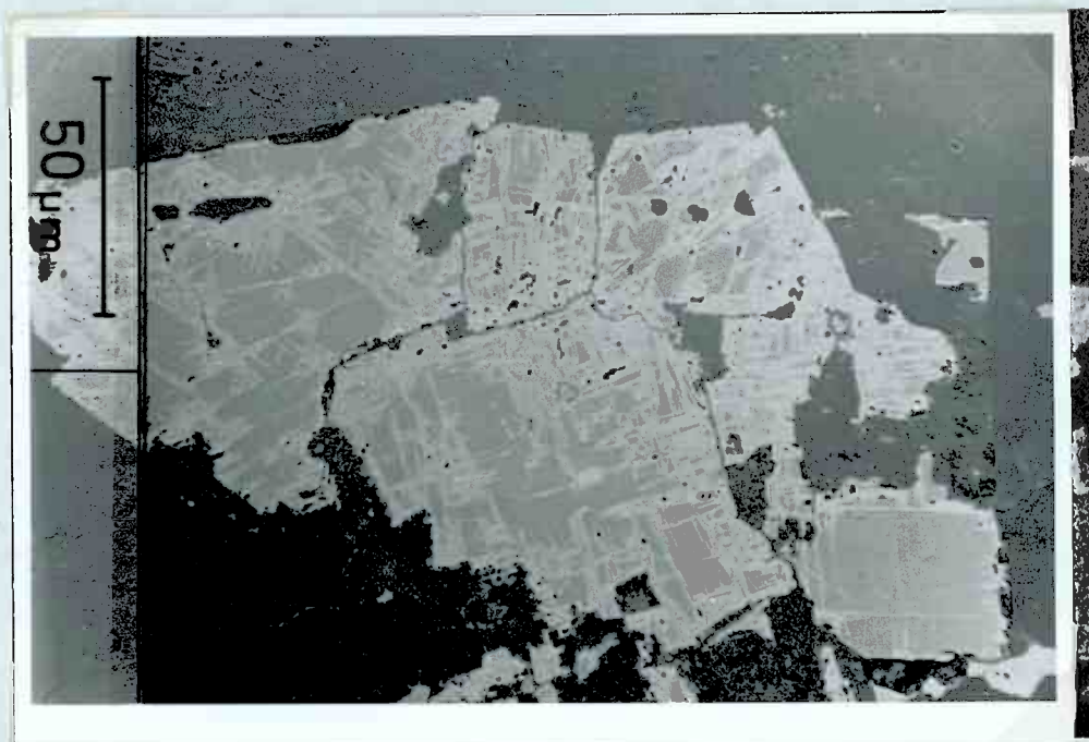
Fig. 26. Prøve 28219. Magnetitaggregat af euhedrale krystaller, der er stærkt martitiseret efter afsondringsretningen (111). Haematiten er særlig i billedets nederste halvdel korroderet og omdannet til limonit, stedvis som pseudomorfose efter magnetiten.
