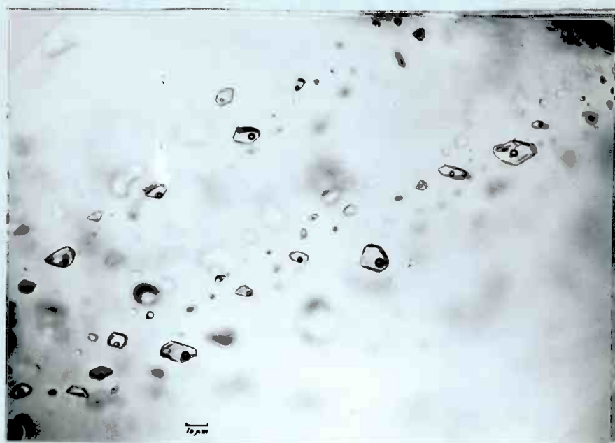
Fig.35. To af flere parallelle retliniede grupper primære regelmæssige v-g indeslutninger af typen I.C.2. Grupperne fortsætter plant skråt ned gennem slibet. I billedets øverste højre hjørne ses korngrænsen, der ikke overskrides af de afbillede grupper. Kvartskrystallens vækstretning går diagonalt over billedet vinkelret på de parallelle grupper.
