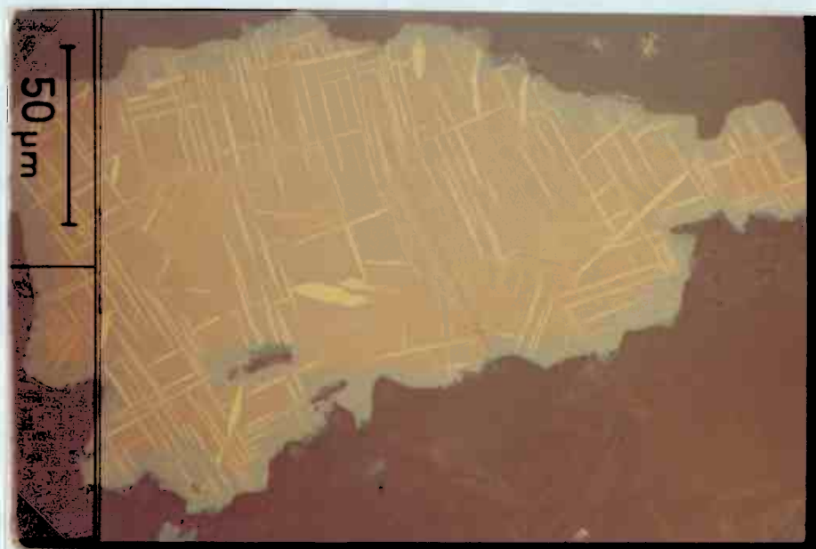
Fig. 14. Prøve 18679. Sammensat bornitkorn med tynde chalcopyrit afblandingslameller efter to krystallografiske retninger samt afblandings-"fisk" efter en tredje retning. Bemærk digenitrand også om chalcopyritlamellerne.
