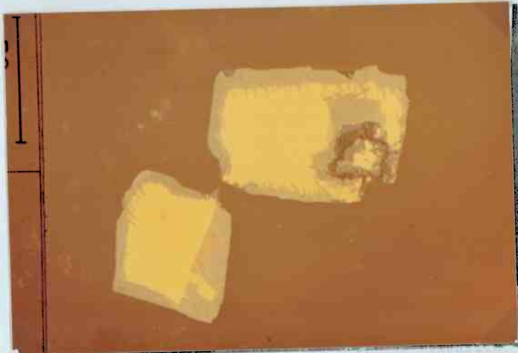
Fig.18. Prøve 18647. Rekrystalliseret euhedral chalcopyrit med reliket af bornit med chalcopyrit- og digenit-afblanding. Begyndende omdannelse til digenit, der stedvis er omdannet til covellin. Bemærk røde indre reflekser i største kornene hjørne. Chalcopyrit-kornene er under omdannelse til digenit i kanten langs krystallografiske retninger.
