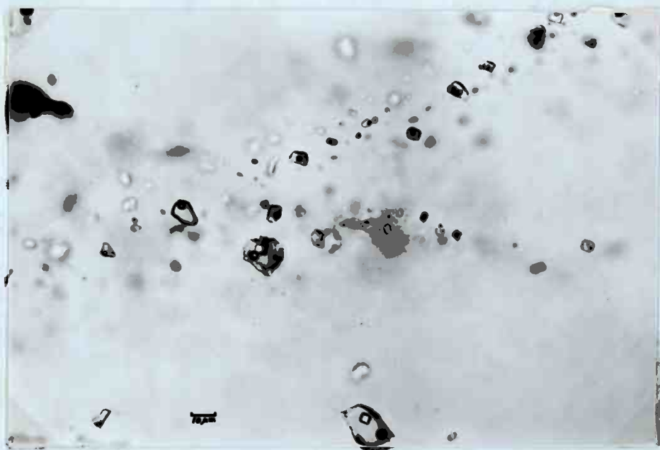
Fig. 40. Sammenløb af 2 sprækker med små v-g og enkelte små v-g-x indeslutninger af typen III.A og B samt en 3. sprække med 2 stor primære (?) v-g-x-x indeslutninger i fokus og i venstre øverste hjørne en tilsvarende ude af fokus. Bemærk de opake globulare korn i de 2 store indeslutninger.
