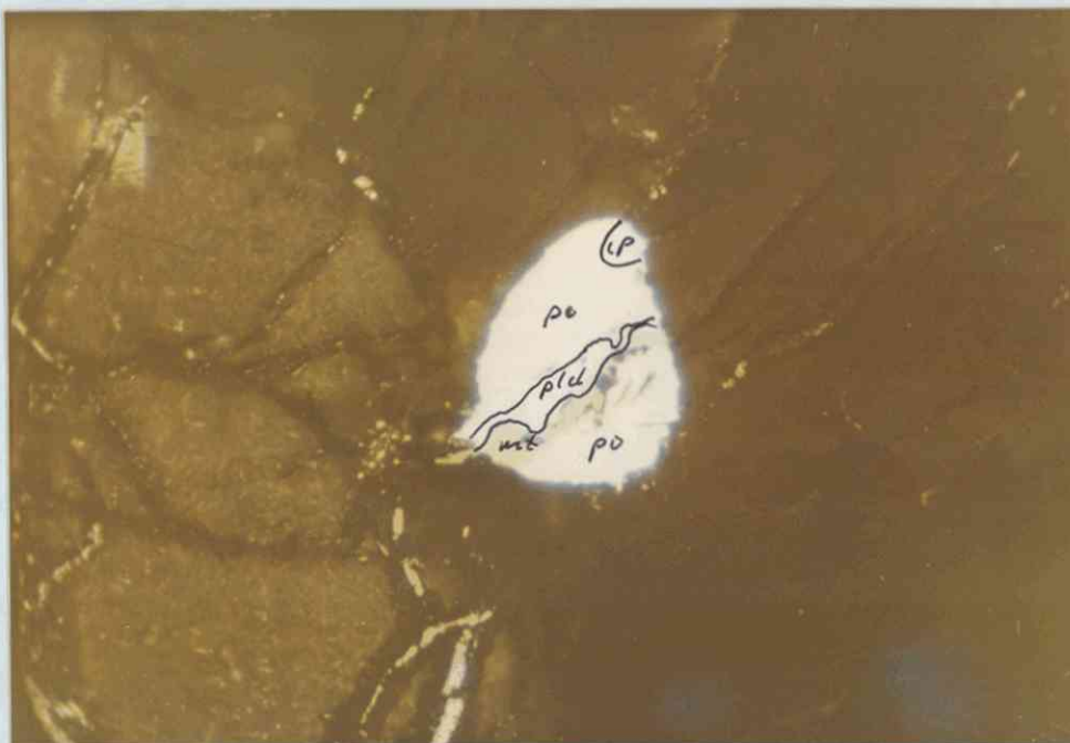
Bilde 3. (i olje). Prøve merket 6. Magnetkis-korn (po) med pentlanditt (pld), kobberkis (cp) og magnetitt (mt).
