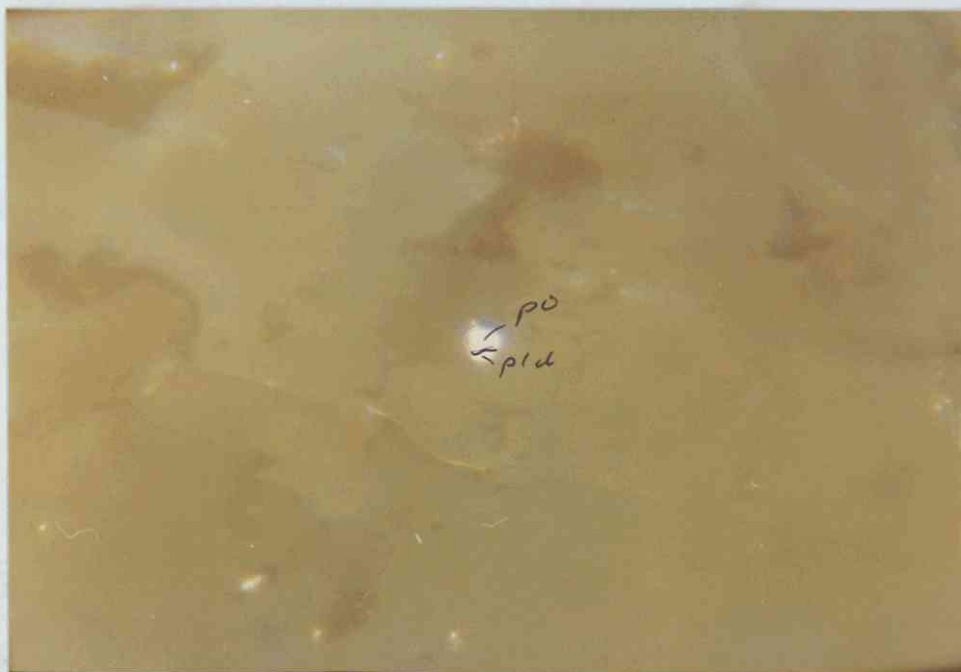
Bilde 4. (i olje). Prøve merket 6. Eksempel på meget finkornig magnetkis (po) med pentlanditt (pld).
