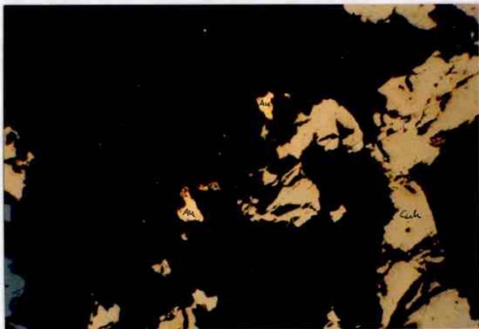
Bidjovagge, B-malmi, näyte N890/E560/63.40 (T1233). Kuparikiisupirote (Cuk) albiittifelsiitissä. Suuren- nus 20x.
