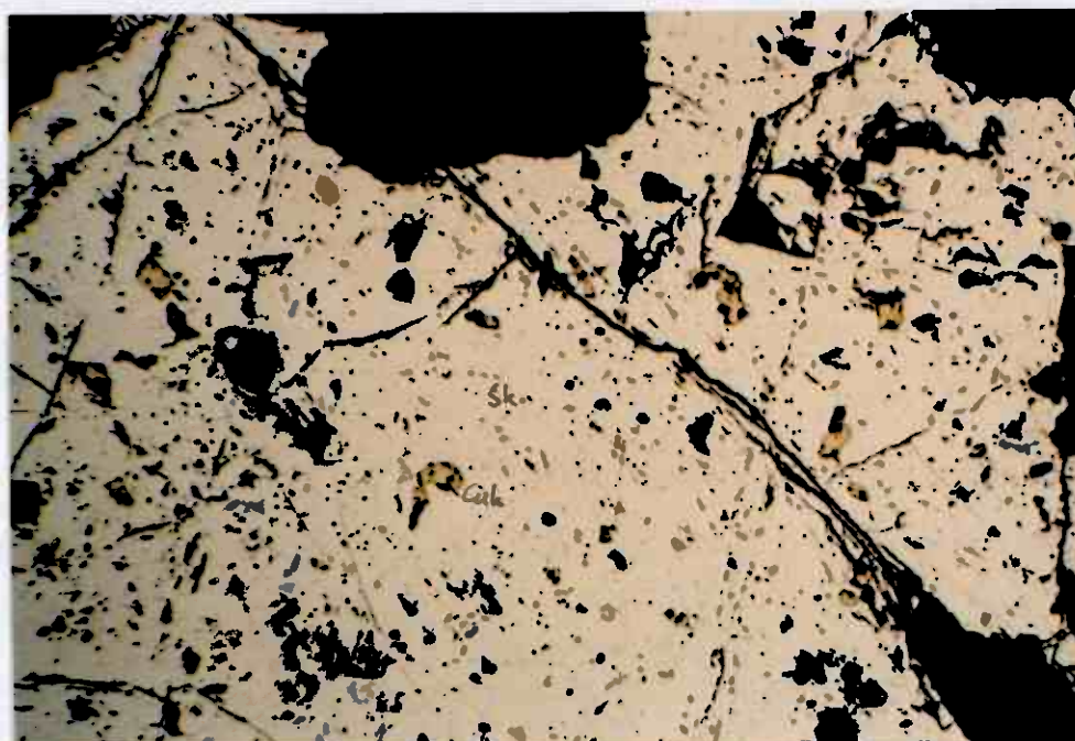
Bidjovagge, C-malmi, näyte S-117-B/99.20 (T1227). Pyriittipirote (Sk) albiittifelsiitissä. Suurennus 20x.
