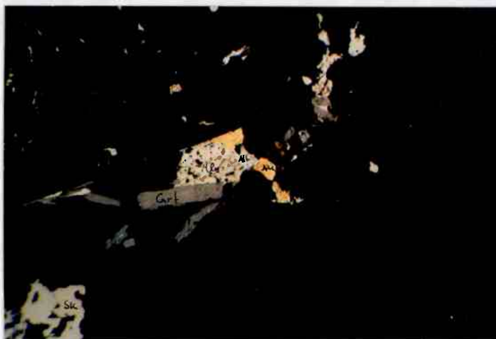
Bidjovagge, B-malmi, näyte N890/E560/69.00 (T1237). Meloniitti (Mln) -altaiitti (Alt) -kulta (Au) -kasauma, Sk = pyriitti. Suurennus 200x.
