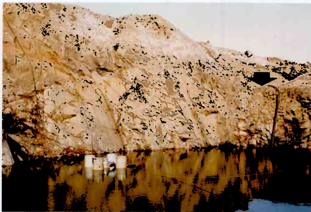
Fig. 5 A. Utsnitt av det nord-vestlige hjørnet av dagbrudd A under lensingen. Pilen angir sone med breksjert og klorittisert albittfels.
