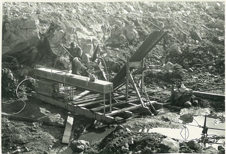
Diamantbormaskin og utstyr på kjelke som greitt tillater boring begge veier.
