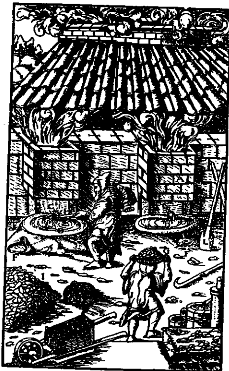
Fig. 2. Ovner til smelting av koppererts fra midten av 1500-tallet (Agricola).
