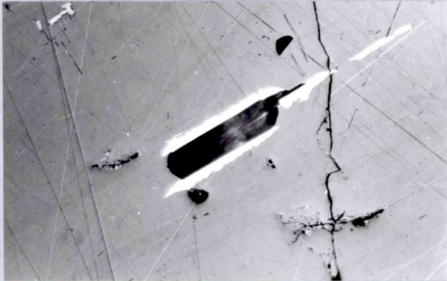
Abb. 13 - Kupferkies als Hauptmineral (mittelgrau, mit einem Riß) enthält eine idiomorphe Hornblende (schwarz, zum Teil durch Innenreflexe hell erscheinend). In beiden Seiten der Hornblende und deren Verlängerung erscheint Mackinawit (weiß) Vergrößerung: 165fach - Gekreuzte Nicols Bursi, Sulitjelma
