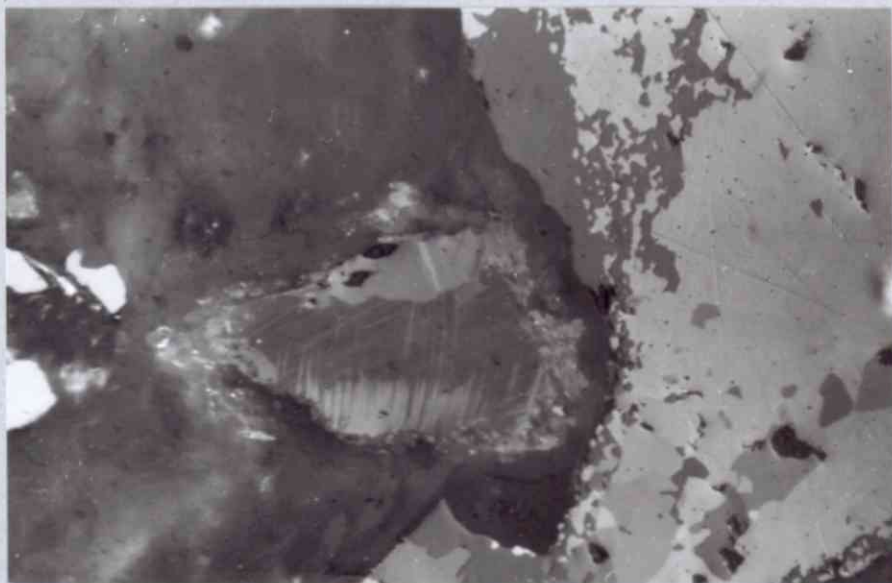
Abb. 8 - wie Abb. 7, jedoch mit gekreuzten Nicols. Man erkennt die Zwillingslamellierung in Rutil und die Innenreflexe des Anatas. Vergrößerung: 250fach - Gekreuzte Nicols Anna-Grube, Sulitjelma
