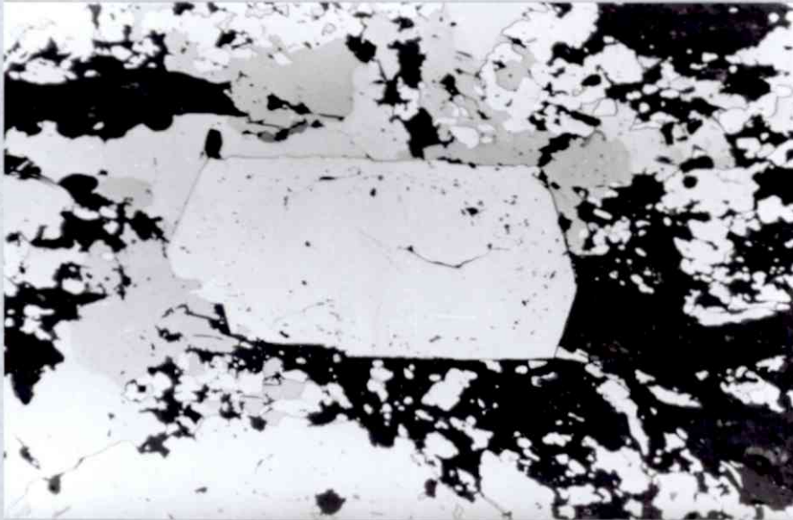
Abb. 3 - Idioblastischer Arsenkieskristall (weiß, Bildmitte) mit Andeutung von Zonarbau eingebettet in ein eingeregelter Gemenge von Kupferkies (ganz zart hellgrau), Pyrit (weiß, xenomorph) und Silikate (dunkelgrau) - Vergrößerung: 56fach - Parallele Nicols Anna-Grube, Sulitjelma
