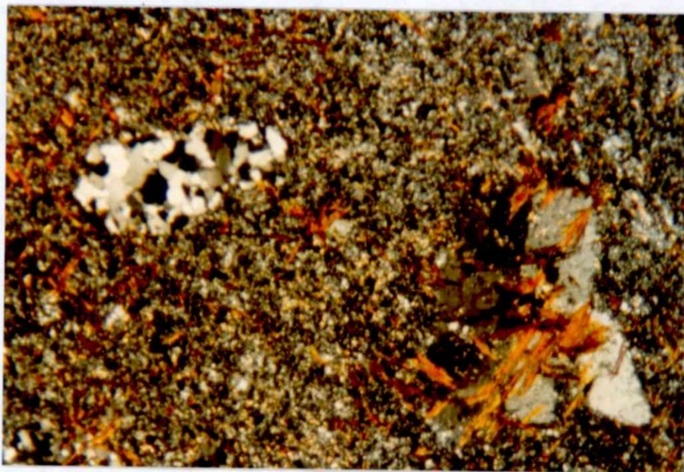
Fig. 16. Tynnslip nr. 14306 (lok. 37) x.nic. Forstørret 40x. Meta-rhyo-dacitt med plagioklas-fenokrystall (t.h.). Den har tvilling, trolig av Karlsbad-type. Noe serisitt i plagioklasen. Det fibrige, brunrøde mineralet er stilpnomelan. Grunnmassen er xenomorf. Øverst til venstre "dråpe"-strukturen (se fig. 12 og 13) i mikroskopisk skala.
