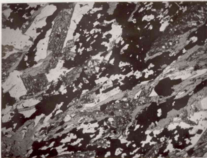
Mikrofoto av vasskis fra Børsa, 20 X, parallelt lys.
