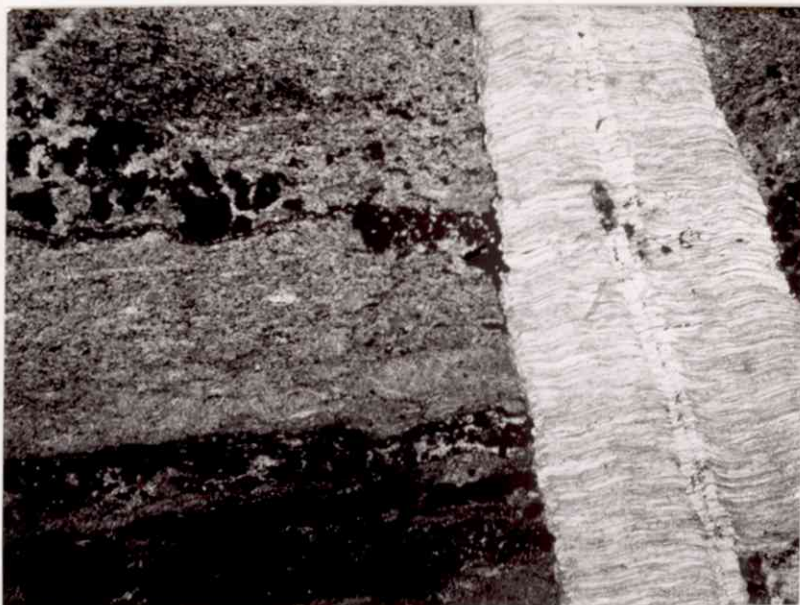
Mikrofoto av vasskis fra Bakindia, 20 X, parallelt lys.
