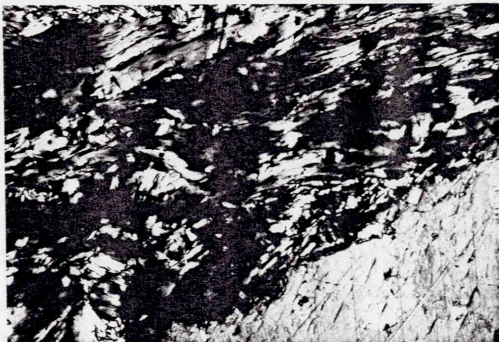
Fig. 16. Mikrofoto av slip 5 - 81,75 m/område 1. 25 x forstørrelse og kryssede nicols. Kloritt ( i øvre venstre del av bildet) og ferro-magnesitt (breunneritt). Jfr. mikrosondeanalyse nr. 15, Bilag 3, side 4.
