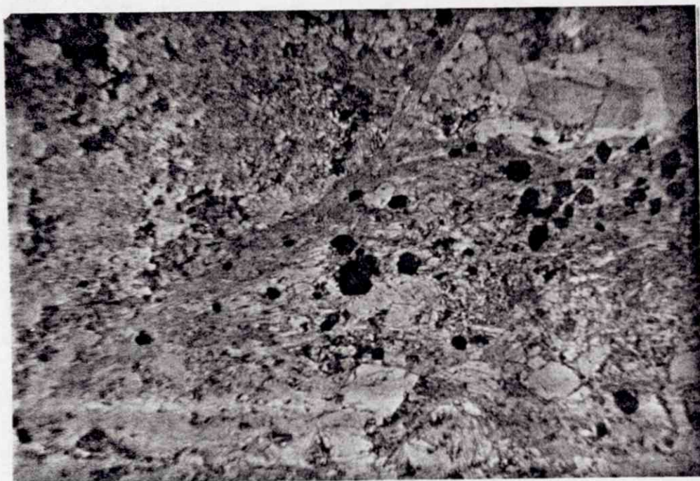
Fig. 7. Mikrofoto av slip 5 - 48,85. 6 x forstørrelse og parallelt lys. Område 1 fra fig. 6 ligger nå i øverste høyre hjørne av bildet. Størrelsen av breunnerittkornene fremgår her tydeligere enn på fig. 6. Til venstre på bildet og under de svarte oksydkornene sees ansamlinger av finkornet dolomitt.
