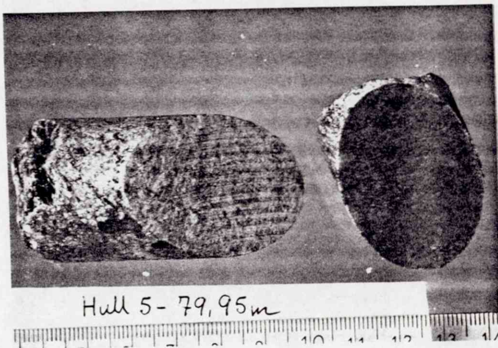
Fig. 13. Kjerneprøve hull 5 - 79,95 m. Omtrentlig mineralfordeling i tilhørende slip: ~80 % talk, 10-15 % kloritt, <1 % aktinolit, 1-2 % sekundær magnetitt pluss kromitt, samt apatitt (?) som aksessorium. I slipet sees klorittdannelse rundt kromittkorn under nedbryting. Klorittdannelsen skyldes frigjøring av Al under nedbryting av kromitten til ferrikromitt og krom-magnetitt. Al reagerer da med talk rundt oksydkornet og kloritt oppstår i reaksjonssonen.
