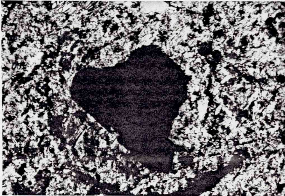
Fig. 29. Mikrofoto av slip 11 - 25,10 m/område 3. Et stort kromittkorn nå omvandlet til ferrikromitt sentralt i bildet omgitt av en talkdominert grunnmasse. Jfr. mikrosondeanalyse nr. 5 i Bilag 3, side 2.
