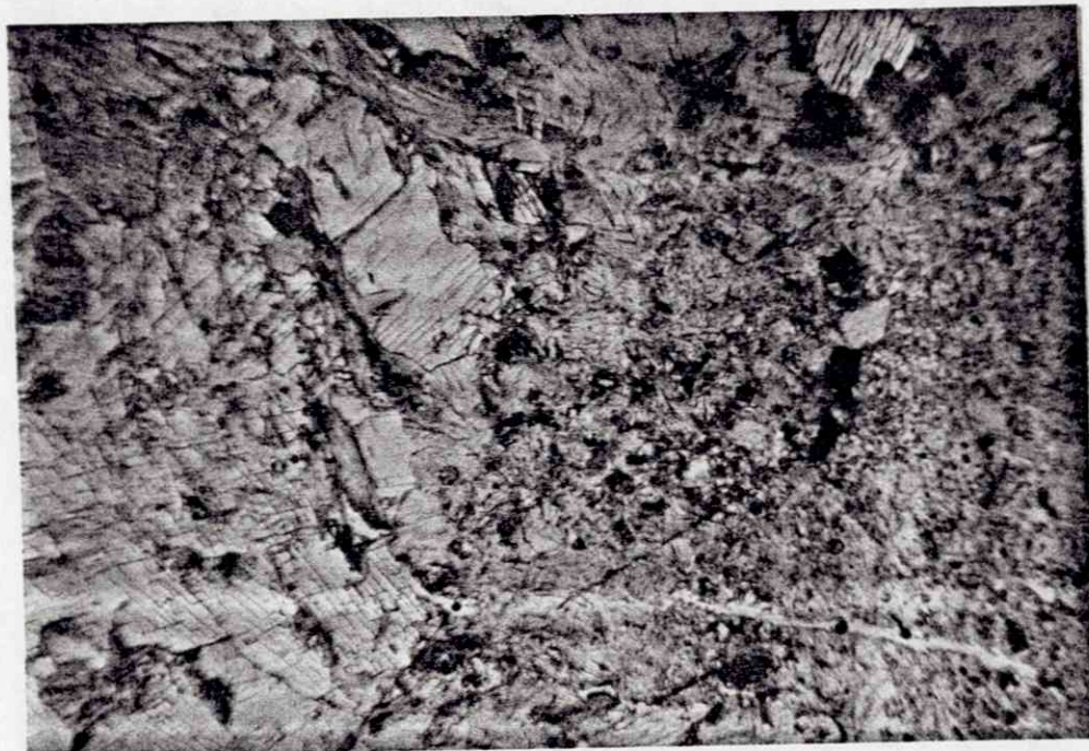
Fig. 21. Mikrofoto av slip 11 - 8,20 m. 12 x forstørrelse, parallelt lys. Karbonat (breunneritt) (hvit) i en talk grunnmasse (noe mørkere).
