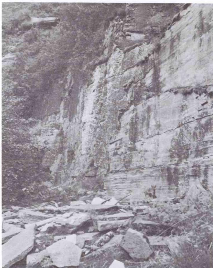
Fig. 22. Bruddområde B i Dalsdalen, hvor de nederste 5 metrene partvis inneholder spaltbar skifer (sett mot vest).
