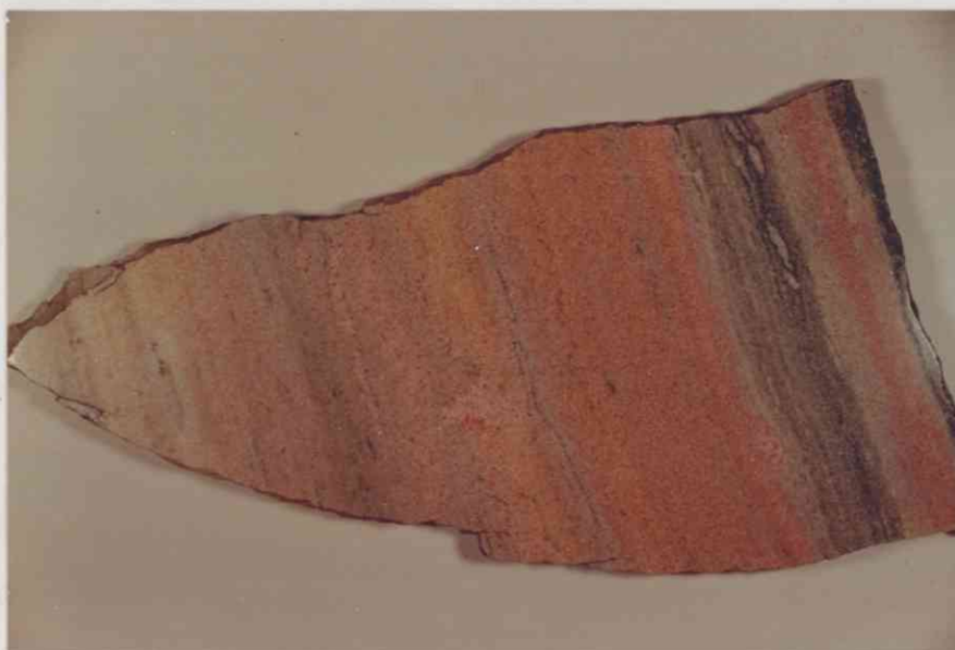
Fig. 2. Polert flate fra prøveblokk av partiet merket J.
