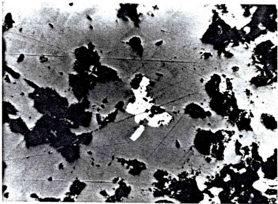
Abb. 11 Oxidation von Magnetit (grau) in Hämatit (weiß), ca. 1100 x in Öl
