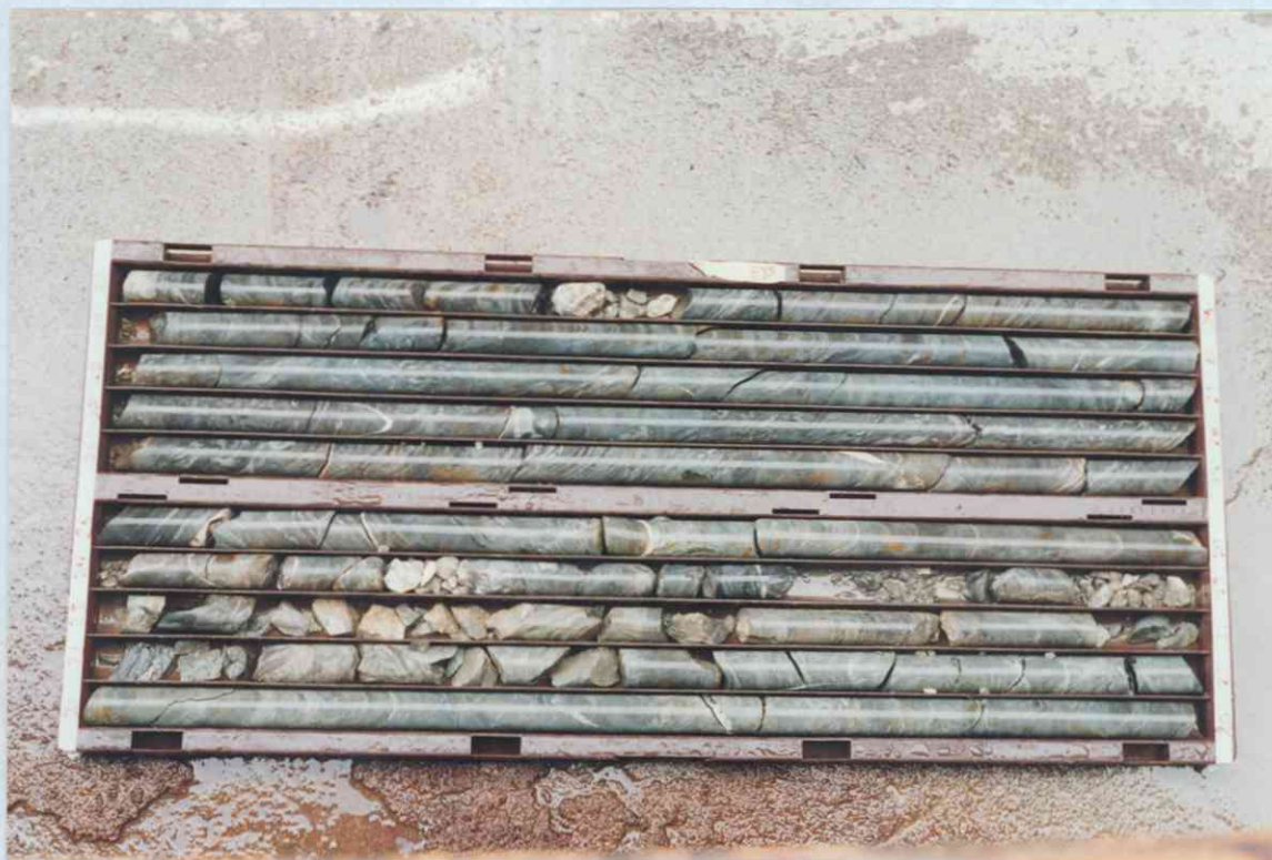
FOTO 3: Borkjerner fra hulldyp 20 m - 30 m
