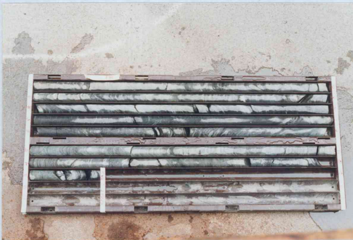
FOTO 1: Borkjerner fra hulldyp 2,80 m - 10 m
