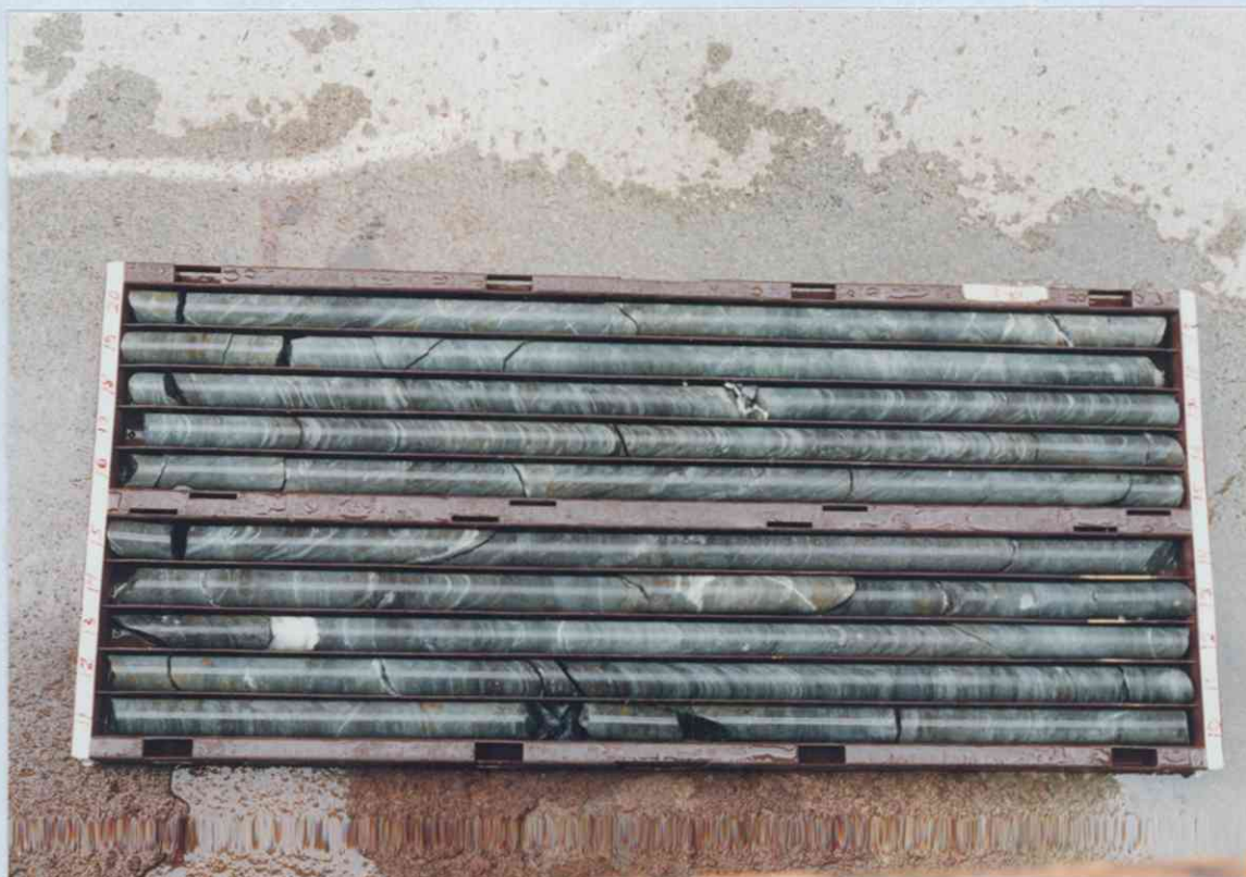
FOTO 2: Borkjerner fra hulldyp 10 m - 20 m
