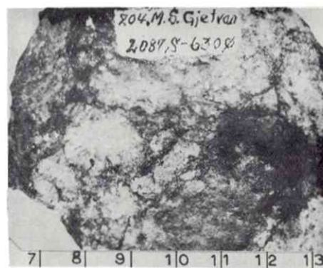
Fig. 4 Prøve nr. 204-1534 Mineralisering av brecciert sparagmitt sort : sulfider skala i cm
