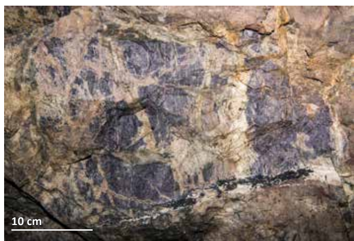
Figure 5.4.2g Fluorite mineralization in FDC breccia. Lichtloch tverrslag, LLT.
