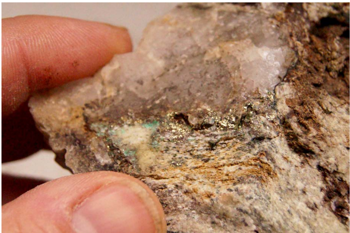
Nærbilde av kobberkorrodering, samme breksje som ovenfor.
