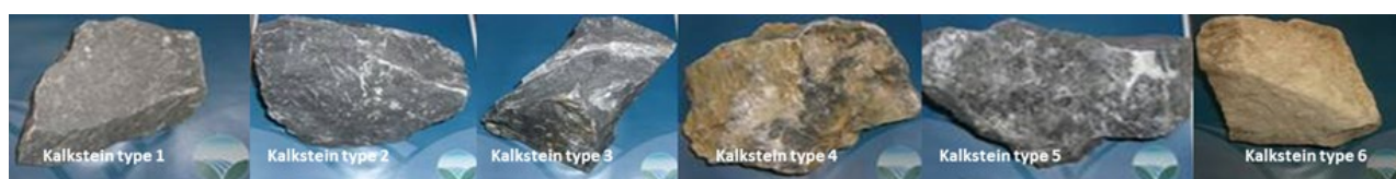
Figur 3: Viser kalksteinstypene i bruddet. På grunn av ulike mineralogiske teksturer vil de forskjellige malmtypene kreve ulik brenning i vertikale sjaktovner.
