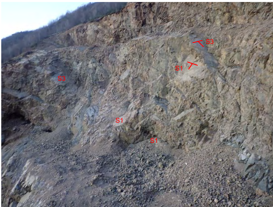
Figur 5. Bergskjæring mellom pall 1 og 2. Tatt mot vest. Sprekkesettene er markert.
