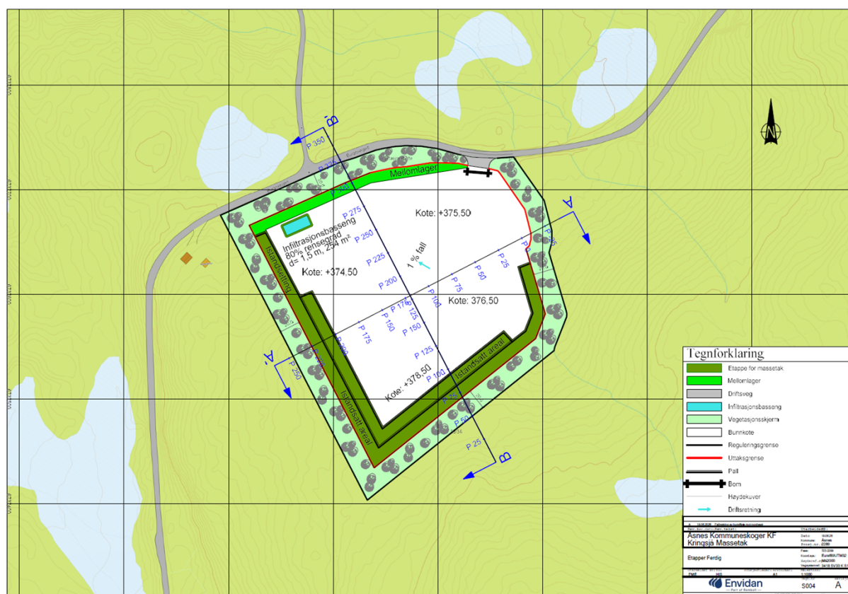
Ferdig uttatt område, plassering av renskmasser og avsluttede paller.
