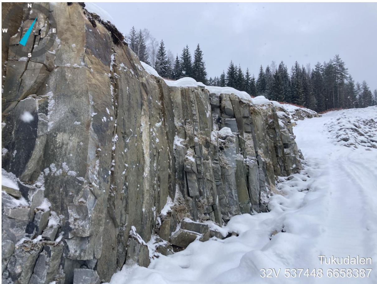
Figur 3: Bilde viser bergmassen i bruddet, en mørk kvartsitt med tydelig vertikal lagdeling. Bilde er tatt vest for adkomstveien i en av skjæringene som er en del av det ferdige bruddet.
