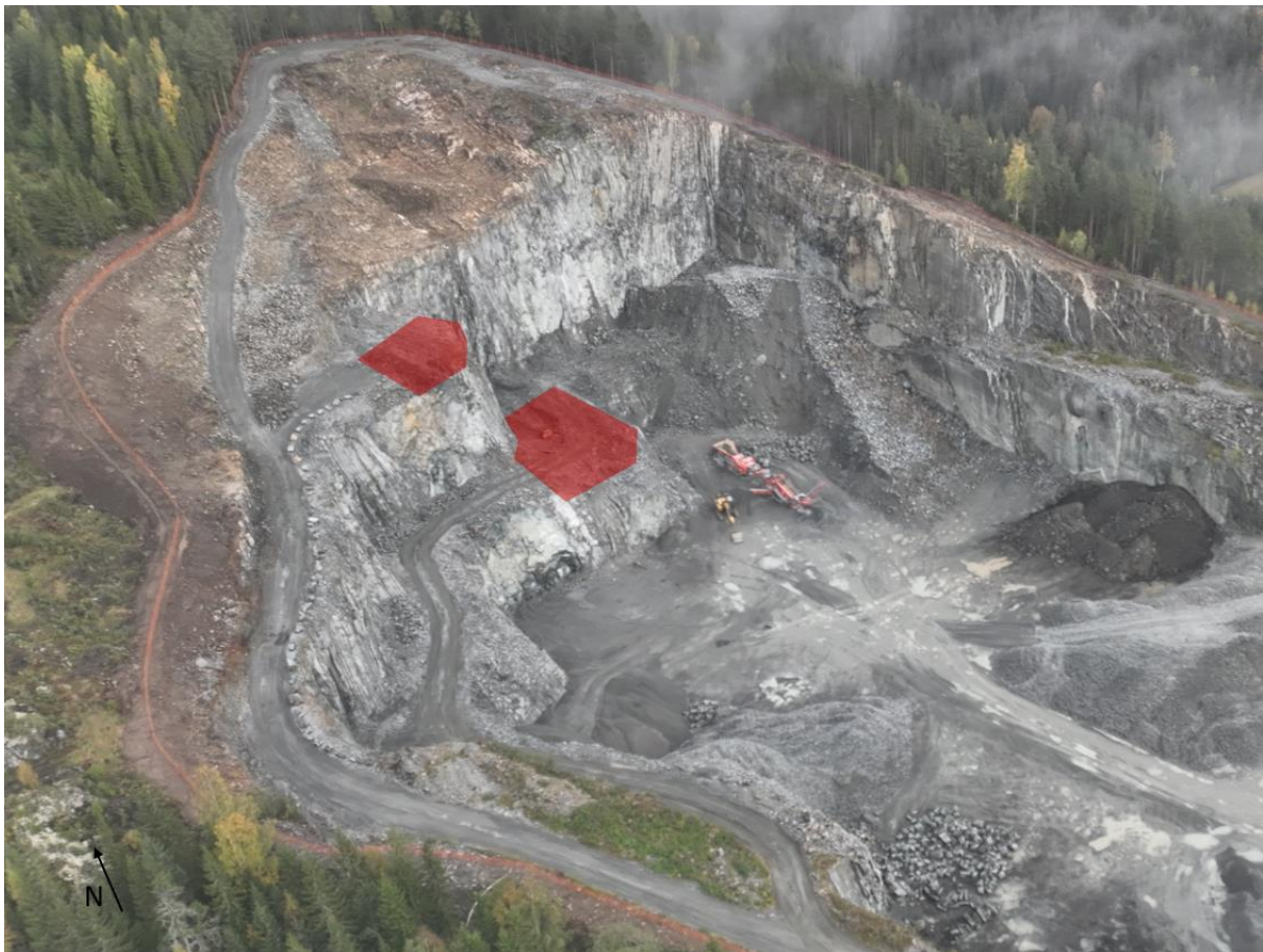
Figur 5: De røde feltene viser hvor de ferdigborede pallene befinner seg i pukverket.
