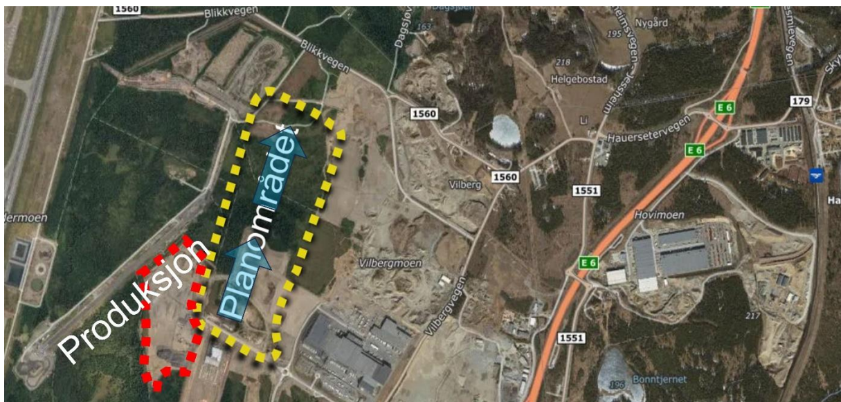
Figur 8 Drivretning markert med lyseblå piler. Man tar ut hele områdets bredde langs drivretningen.
