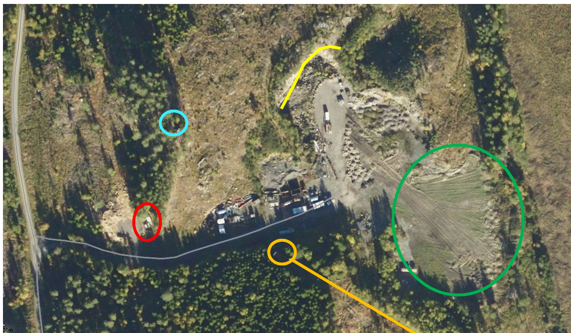
Figur 7. Dagens situasjon på Bakkeberget. Rød sirkel viser sprengstofflager. Blå sirkel viser telemast, mens oransje linje og sirkel synliggjør høgspent og trafo. Bruddkant fra 1999 vises med gul strek og deponi er vist til med grønn sirkel.
