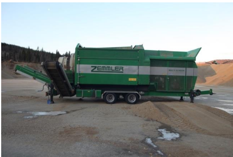
Figur 12: Sorteringsanlegg som står plassert i eksisterende massetak.
