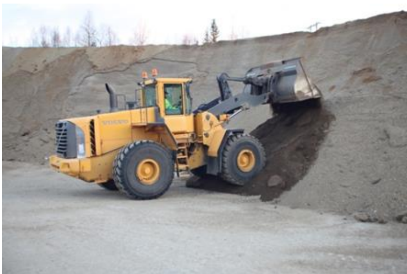
Figur 11: Foto som viser uttaksmetode med hjullaster direkte fra stuff.
